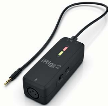
Vorverstärker iRig Pre 2 von IK Multimedia zum Anschluss von XLR-Mikrofonen an Miniklinkebuchsen. Zwei AA-Batterien ermöglichen eine Phantomspeisung. Foto: ikmultimedia.com
